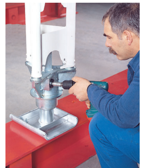
Do obsługi wystarczy zwykła wiertarko-wkrętarka z nasadką do klucza o rozwarości S 19. Nie używać wiertarko-wkrętarek udarowych!
